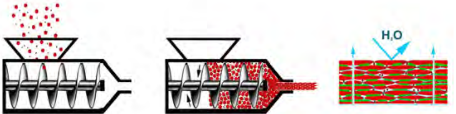
Proceso y estructura materiales extrudidos Gres Aragón. Process and structure of Gres Aragon extruded materials.
